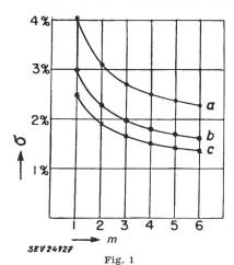
Statistischer Fehler beim Prüfen von elektrischen Kleinmotoren
