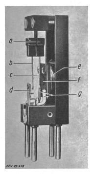
Fig. 1 Aufbau des Resonanzrelais
