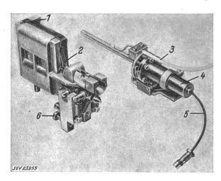
Fig. 2 Düsenschreiber (Siemens-Reiniger Werke)
