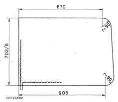
métalliques et enrobés de masse céramique. Fils chauffants serrés entre les feuilles métalliques. Ces glaces chauffantes sont destinées aux véhicules routiers et de traction, aux avions, aux hôtels, aux devantures de magasins, etc.
