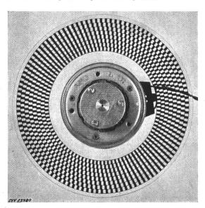
Fig. 3 Tonspurscheibe mit Synchronmotor
