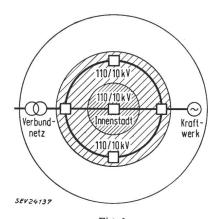
Fig. 1 Schematische Darstellung eines 110/10-kV-Netzes einer Stadt mit idealisiertem Energieverbrauch
