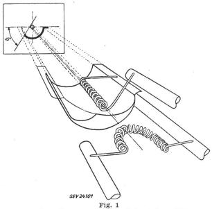
Aufbau eines europäischen Autoscheinwerfers Unten rechts die Spirale des Fernlichtes, möglichst nahe dem Brennpunkt
