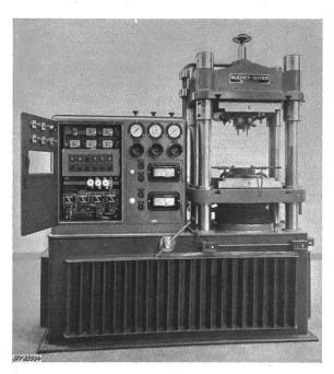
Fig. 1 150-t-Kunstharzpresse mit elektrischer Steuereinrichtung
