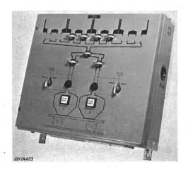
Fig. 2 Steuerapparatur für Zement-Loseverlad
