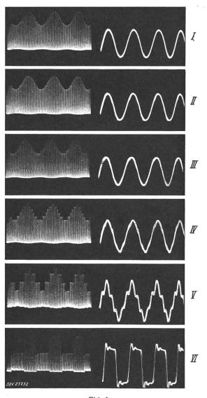
Fig. 1 Signalqualität als Funktion der Stufenzahl links HF-Signal; rechts NF-Signal d Klirrfaktor des ganzen Systems; fNF
