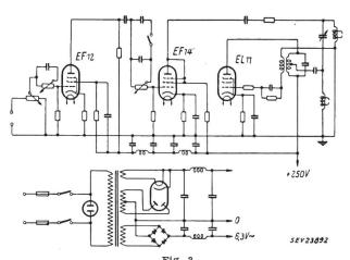
Fig. 2 Prinzipschaltschema des Aufsprechteils am Tiefton-Magnetgerät
