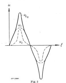
Zusammensetzung der Lampen-Leerlaufspannung u Spannung; t Zeit; u.o Lampen-Leerlaufspannung (Spannung an den Lampenelektroden bei nichtzündender Lampe); u. Netzspannung; u. Impulsspannung (Zündungsimpuls)
