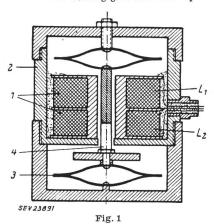
Schnittbild eines trägerfrequenten Schwingungsaufnehmers mit veränderbarer gegenseitiger Induktion zweier Spulen 1 zwei voneinander getrennte Spulen L<sub>1</sub> und L<sub>2</sub>; 2 zylindrisches Gehäuse; 3 Blattfedern; 4 Tauchkern
