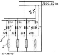
Fig. 1 Prinzipschaltung der Helligkeitssteuerung
