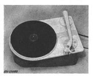
dispositif d'entraînement sont fixés à une plaque d'aluminium recouverte d'une plaque en matière isolante moulée. Lecteur de son à cristal pour disques normaux et à microsillons. Cordon méplat avec fiche pour raccordement au réseau et câble spécial blindé avec fiches pour raccordement au phonographe. Ce tourne-disques est prévu pour logement dans un boîtier en bois.
