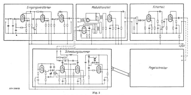
Prinzipschaltschema des Suchtonanalysators
