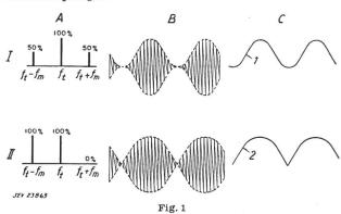
Einfluss der ungleichmässigen Übertragung der zwei Seitenbandfrequenzen auf die demodulierte Tonfrequenz I normale Seitenbandverhältnisse; II unteres Seitenband vorzugsweise übertragen, oberes Seitenband abgeschwächt über-
