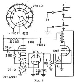
Schaltung mit Photozellen-Vervielfacher für mobile Anwendung mit einem Verstärkungsfaktor  $v=60\,$  db A Abblendung; S Scheinwerfer
