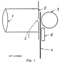
Einfachste optische Anordnung für Abblendung mittels Abtastscheibe
