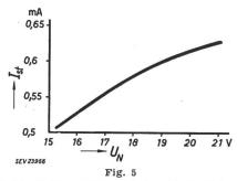
Einfluss der Netzspannung auf den Kontrollstrom eines Magnetverstärkers bei gleichbleibendem Ausgangstrom Ist Steuerstrom; UN Netzspannung
