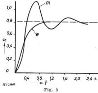
Vergleich eines Regelsystems mit zwei Zeitkonstanten von  $T_1 = 0.2$  s und  $T_2 = 0.6$  s
