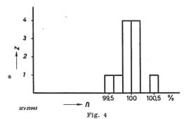
Streuung eines mit elektronischem Verstärker geregelten Ward-Leonard-Antriebes bei Verwendung von 11 verschiedenen Verstärkerröhren z Anzahl Röhren; n Drehzahl
