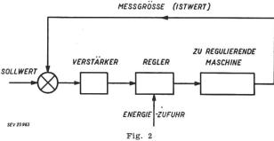
Blockschema eines geschlossenen Regelkreises
