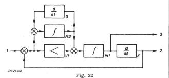
Schéma de l'équipement de mesure de consommation du carburant selon fig. 21
