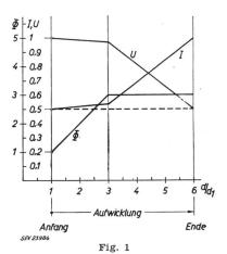
Verlauf von Ankerspannung U, Ankerstrom I und Feldstärke  $\Phi$  des Wickelmotors während des Aufwickelvorganges  $d_1$  Wickeldurchmesser zu Beginn des Aufwickelvorganges; d jeweiliger Durchmesser während des Aufwickelns
