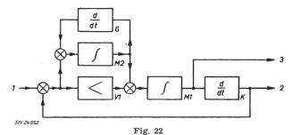
Schéma de l'équipement de mesure de consommation du carburant selon fig. 21
