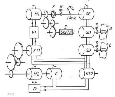
rotor du transmetteur demeure un peu en arrière de sa position de consigne. Il se produit donc au synchro-détecteur  $KT\ 2$  un signal d'erreur et le servomoteur auxiliaire  $M\ 2$  commence à tourner. Le rotor du synchro-détecteur  $KT\ 1$  est alors dé-
