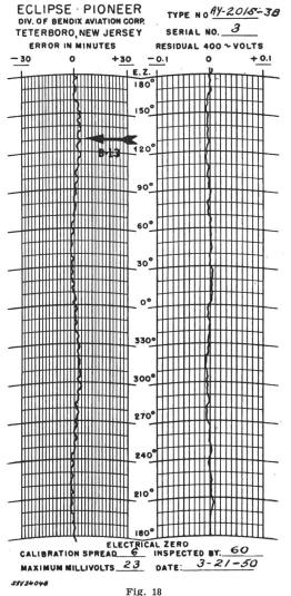
Enregistrement d'une courbe d'étalonnage d'un synchro de précision
