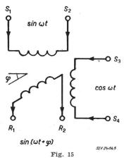
Utilisation d'un resolver comme déphaseur de précision  $S_1...S_4$  bornes de connexion des enroulements du stator;  $R_1$ ,  $R_2$  bornes de connexion de l'enroulement du rotor;  $\varphi$  angle entre l'enroulement du rotor et un enroulement du stator
