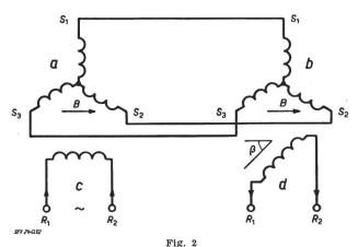
Liaison autosynchrone composée d'un synchro-transmetteur et d'un synchro-détecteur
