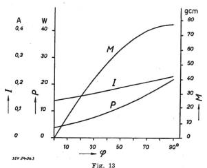
Couple M, intensité I et puissance P d'un récepteur de téléaffichage en fonction de l'angle de dérive  $\varphi$  (erreur angulaire de l'arbre électrique)
