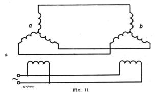
Liaison autosynchrone composée d'un transmetteur et d'un récepteur de téléaffichage ou de télécommande (arbre électrique)
