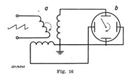
Utilisation du resolver pour la transmission de l'angle d'azimuth de l'antenne directive d'un radar au tube cathodique
