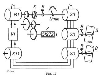
Equipement de mesure de la consommation de carburant d'un avion multimoteur
