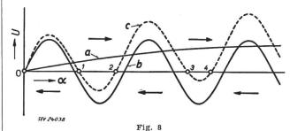
Calage à des positions zéro incorrectes lors de la superposition directe des signaux d'erreur de la chaîne principale et de la chaîne auxiliaire
