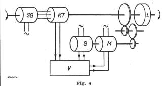
Asservissement de position avec appareils synchros et amortissement à l'aide d'une contre-réaction tachymétrique SG synchro-transmetteur; KT synchro-détecteur; G génératrice tachymétrique asynchrone; M moteur d'asservissement:
