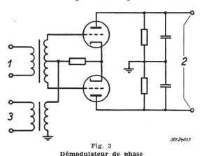
1 Entrée du signal d'erreur provenant du synchro-détecteur 2 Sortie du signal d'erreur démodulé
