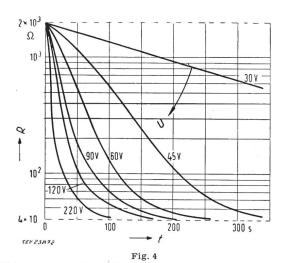
Widerstandsabnahme eines Heissleiters grosser Masse als Funktion der Zeit bei verschiedenen Spannungen
