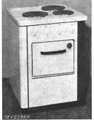
Cuisinière électrique, selon figure, avec trois foyers de cuisson et un four, pour adossement à un potager à bois ou charbon. Plaques de cuisson de 180 (1 plaque) et 220 mm de diamètre, avec bord en tôle d'acier inoxydable, fixées à demeure. Corps de chauffe disposés à l'extérieur du four et réglés ensemble par un thermostat. Bornes prévues pour différents couplages. Poignées isolées.
