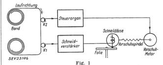
Anordnung zum Plattenschneiden mit einem Vorschub, der von der aufzuzeichnenden Amplitude abhängig ist  $K_1$ ,  $K_2$  Magnet-Tonköpfe
