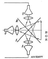
Fig. 1 Schematische Darstellung der Empfängeranordnung für das Simultan-Farbfernsehen
