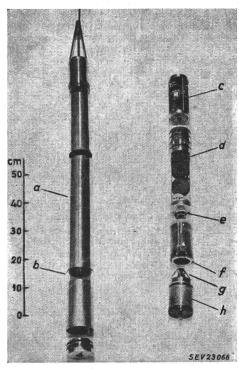
Fig. 1 Bohrlochkamera
