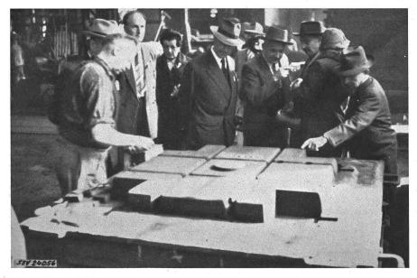
Die Besucher konnten die Arbeiten an einem riesigen Plattenbohrwerk mit einer Antriebsleistung von 51,5 kW (70 PS) verfolgen. Als Arbeitstück war der Leitradring zu einer Kaplanturbine für das Kraftwerk Rheinau im Gewicht von 50 t aufgespannt.
