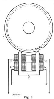
Construction de principe des générateurs de mesure 1 disque denté; 2 stator avec pièces polaires; 3 enroulement de la tension induite; 4 enroulement de l'excication
