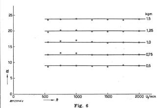
Résultats de mesure du dispositif pour la mesure du moment de torsion
