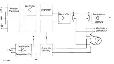
torsion quelconques (fig. 5). Comme nous avons déjà vu la construction du dispositif de mesure a permis de calibrer l'instrument en kgm. La fig. 6 montre les résultats des mesures reçus à l'aide du nouveau dispositif. Les courbes montrent les déviations de l'instrument; les paramètres sont la vitesse et le moment de torsion. La vitesse s'étend entre les limites de 500...2000 t./min.
