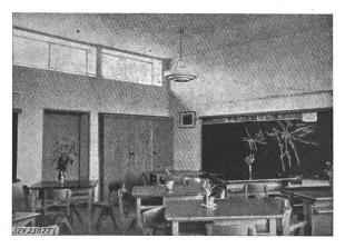
Fig. 3 Zweiseitig beleuchteter Schulraum mit zusätzlichem Fensterband in der dem Hauptfenster gegenüberliegenden Wand
