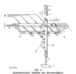
Z Schaltstangen-Zahn, über die Schaltstange S mit dem Pluspol leitend verbunden; D Schaltdraht, im Aggregat A isoliert montiert, mit rückwärtigen Anschlussdrähten B nach dem Blindschema; P Ankerpol; F Rückzugfeder Weitere Bezeichnungen siehe im Text
