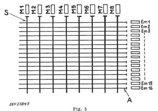
Kreuzwähler-Anordnung für  $8 \times 16 = 128$  Kreuzpunkte S Schaltstangen mit Hubmagneten M; A Aggregate mit Magnetspulen Em
