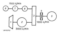
Principe de la disposition d'un alternateur monophasé et d'un alternateur triphasé dans une usine génératrice thermoélectrique, selon Marguerre
