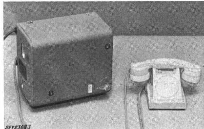
biné du poste téléphonique de table, qui peut également servir d'écouteur. Alimentation par transformateur à enroulements séparés. Entraînement du disque enregistreur par moteur à induit en court-circuit. Amplificateur à deux tubes électroniques, avec translateur téléphonique d'entrée, logés dans un boîtier métallique. Cordons de section circulaire, fixés à l'appareil, pour raccordement au circuit téléphonique et au réseau. Possibilité de branchement d'un dictaphone.
