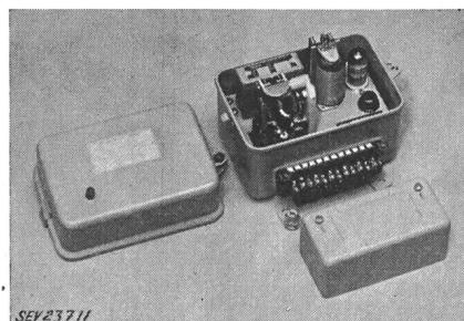
électrique. Coffret en tôle renfermant un tube amplificateur, un relais inverseur, un interrupteur bimétallique de verrouil-
