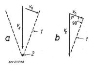
Fig. 2 Lineare Wellenfront einer mit der Geschwindigkeit  $v_x$  bewegten Punktquelle bei einer Wellenfortpflanzungsgeschwindigkeit  $v_{\theta}$
