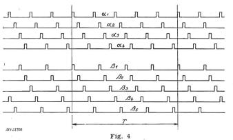
Impulsprogramm für 20 zeitliche Identifikationen (Impulse gleicher Dauer)
