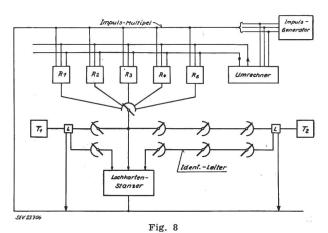
Anwendungen der Impuls-Identifikation  $T_1$ ,  $T_2$  Teilnehmer; L Linienstromkreise der Teilnehmer;  $R_1...R_5$  Register
