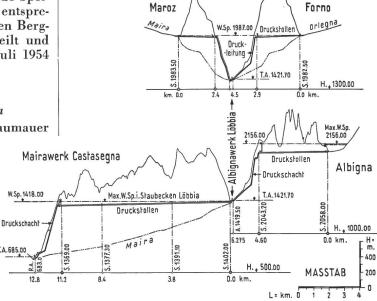
der gesamten Bergeller Kraftwerkgruppe beurteilt, ein nutzbarer Stausee-Inhalt von 60 · 106 m³ als die wirtschaftlichste Lösung ermittelt. Das Stauziel kommt dabei auf die Kote 2156 und die Mauerkrone 2 bis 3 m höher zu liegen; die grösste Mauerhöhe misst 110 m und die Kronenlänge 755 m. Die topographische Gestaltung der beiden Talflanken bedingt eine zweimalige Brechung der Mauerachse, so dass die beiden Mauerflügel gegen Süden abgeschwenkt sind (Fig. 3).
