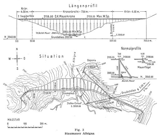
Lageplan, Profil durch die Staumauerachse und Schnitte Staubecken: Maximaler Wasserspiegel 2155.55 m ü. M.; minimaler Betriebs-Wasserspiegel 2065.00 m ü. M. Nutzbarer Inhalt  $60\cdot10^6$  m³
