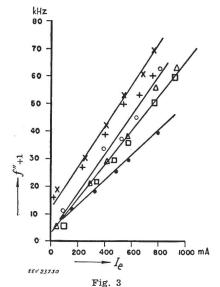
Obere Grenzfrequenz  $f''_{+1}$  in Funktion des Emitterstromes  $I_{\sigma}$  und der Kollektorspannung  $U_{\sigma}$  in Emitterbasisschaltung
