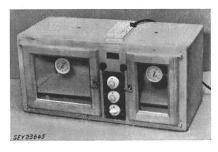
avec interrupteurs «Miltac», pour le réglage indépendant de la température des compartiments. Commutateurs rotatifs et lampes témoins montés entre les portes. Boîtes de raccordement au-dessus de l'étuve. Cordon de raccordement renforcé à trois conducteurs, fixé à l'étuve, avec fiche  $2\ P+T$ .
