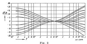
Die mit der Schaltung Fig. 1 gemessenen Entzerrerkurven bei verschiedenen Potentiometerstellungen
