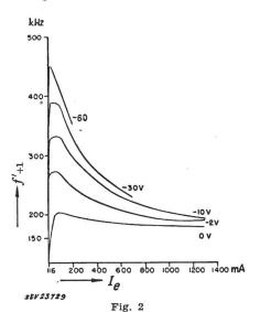
Obere Grenzfrequenz  $f'_{+1}$  in Funktion des Emitterstromes  $I_{\theta}$  des Transistors Nr. 355 gemessen in der Schaltung mit gemeinsamer Basis bei verschiedenen Kollektorspannungen
