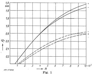
Trolleybusbetriebe Rom, starres System Pf Fahrdraht-Abnützung; n Anzahl Bestreichungen
