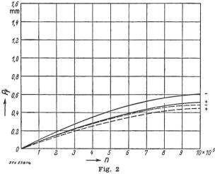
Trolleybusbetriebe Triest, vollelastisches K&M-System  $P_f$  Fahrdraht-Abnützung; n Anzahl Bestreichungen
