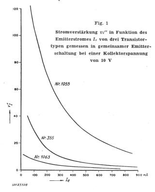
Für einen Transistor in gemeinsamer Emitterschaltung ist die Stromverstärkung  $v_{l}$ " definiert als:
