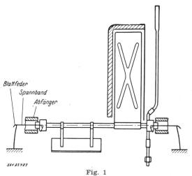
Prinzip der kurzen Spannbandlagerung
