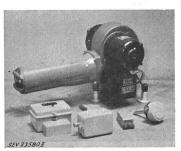
tension du transformateur d'allumage adossé. Commande par appareil automatique de couplage «Sauter», type OB61, thermostat de cheminée «Sauter», type TCHC, thermostat de chaudière «Sauter», type TSC, et thermostat d'ambiance «Landis & Gyr», type TR 3erl.
