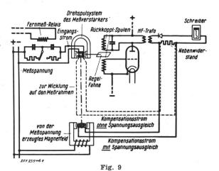
Fernmessverstärker mit Spannungsausgleich Prinzipschaltung der Messanordnung für die Registrierung des Kondensator-Ladestroms auf der Empfangsseite einer Impulsfrequenz-Fernmessung
