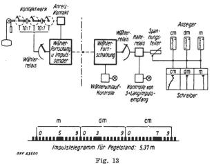
Fig. 13 Schema der Flüssigkeitsstandmessung nach dem Impulstelegramm-Verfahren mit Hilfe von synchron laufenden Wählerrelais
