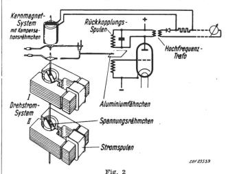
Messwertumformer mit elektrodynamischem System Prinzipschaltung des ausgeführten Gerätes
