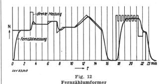
Vergleich einer direkten Messung mit einer Fernzählmessung
