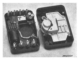
Fig. 11 Stossfestes Universalinstrument
