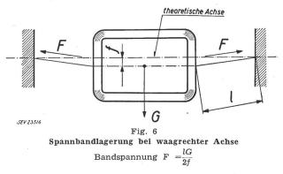
Fig. 6 zeigt die Verhältnisse bei Spannbandlagerung und waagrechter Achse (Normalfall bei Schalttafel-Instrumenten).
