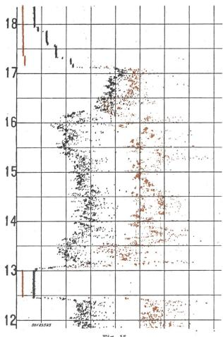
Fig. 15 Wirk- und Blindleistungsdiagramm einer mechanischen Werkstatt
