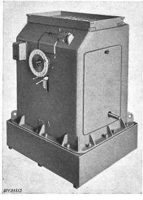
Fig. 3 Maschine für Stossprüfung
