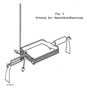
zip der Spannbandlagerung zeigt Fig. 5. Die Drehspule ist an zwei kurzen Spannbändern aufgehängt, die als Lagerung, als Stromzuführung wie auch als
