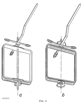
Aufbau des beweglichen Messwertteiles eines Drehspulinstrumentes a starre, durchgehende Achse; b aufgesetzte Achsspitzen
