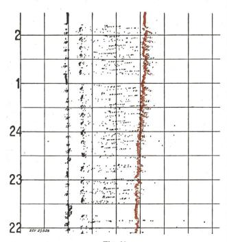
Fig. 16 Wirk- und Blindleistungsdiagramm einer schweren Kopierdrehbank
