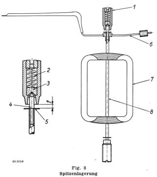
1 Steinschraube; 2 Feder; 3 Stein; 4 Achsspitze; 5 Anschlagscheibe; 6 Balancearm; 7 Rähmchen; 8 Rohrachse
