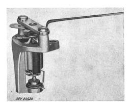
Fig. 10 Drehspulmesswerk mit gefederten Spitzenlagern
