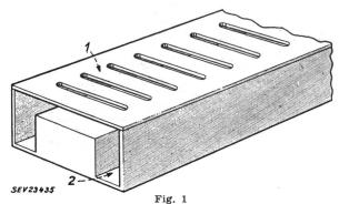
Prinzipieller Aufbau der neuen Verzögerungsleitung 1 Geschlitzte Hohlleiterwand; 2 Belasteter Hohlleiter
