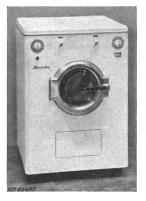
Machine à laver, selon figure, avec chauffage et chauffe-eau à accumulation incorporé. Tambour à linge en acier inoxydable, tournant alternativement dans un sens et dans l'autre. Inversion par commutateur de pôles. Entraînement par moteur triphasé ventilé, à induit en court-circuit, à deux vitesses pour lavage et essorage centrifuge. Commutation manuelle. Barreaux chauffants sous gaine métallique dans le réservoir à lessive et dans le chauffe-eau. Interrupteur pour le chauffage,
