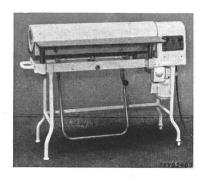
du rouleau par moteur triphasé, ventilé, à induit en courtcircuit, par l'intermédiaire d'un réducteur de vitesse à engrenages et d'une transmission par chaîne. Le rouleau peut être découplé du réducteur de vitesse. Trois interrupteurs à bascule pour le moteur et le chauffage. Thermostat pour le réglage de la température de la plaque chauffante. Lampes témoins sur le devant de la machine. Poignées isolées. Cordon de raccordement à quatre conducteurs isolés au caoutchouc, fixé à la machine.
