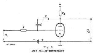
Mit dem sogenannten Miller,Integrator (siehe Fig. 3) wird durch eine Rückkopplung von der Anode zum Gitter der Triode über das rC-Netzwerk ein kleinerer Amplitudenfehler erreicht. Das Verhalten des Miller-Integrators ist ebenfalls aus der Fig. 5 zu entnehmen. Er ist einem einfachen RC-Integrator äquivalent, bei dem der Faktor  $\propto$  durch  $\propto v_0$  ersetzt wird, wobei  $v_0$  die Verstärkung der Triode ohne Rückkopplung bedeutet.
