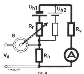
Lindeck—Rothe-Kompensator zur Messung von Spannungen mit wechselnden Vorzeichen
