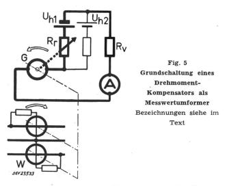
ben, sondern auch bei diesem muss die Stromzuführung zu den Drehspulen durch richtkraftlose Bändchen erfolgen. Ein vom Wattmeter erzeugtes Drehmoment dreht die Drehspule in einer bestimmten Richtung. Dadurch ändert sich der Widerstand  $R_r$  in der Weise, wie das beim Gerät nach Fig. 3 und 4 beschrieben wurde, und so dass der Hilfsstrom grösser wird. Dieser erzeugt in der Drehspule des Null-Motors ein Drehmoment entgegengesetzter Richtung. Sind die beiden Drehmomente
