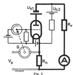
Schaltung eines automatischen Lindeck—Rothe-Kompensators
