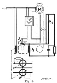
Schaltung eines Grossanzeigegerätes mit induktivem Geber
