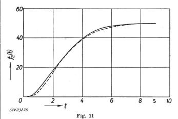
Einschwingvorgang eines 3-stufigen, RC-gekoppelten Verstärkers
