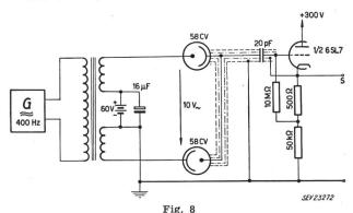
Schaltschema der photoelektrischen Brücke
