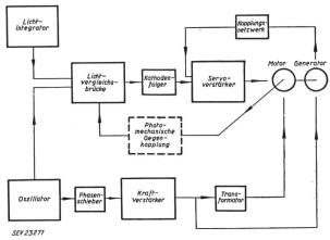
Fig. 7 Blockschema der Auswertungseinrichtung
