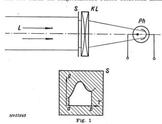
Das Prinzip der optischen Integration L Lichtbündel; S Schirm; KL Kondensorlinse; Ph Photozelle Übrige Bezeichnungen siehe Text
