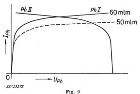
Strom-Spannungsdiagramm der Serieschaltung zweier Photozellen
