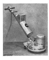
Circuse, selon figure, avec une brosse rotative plate de 380 mm de diamètre. Entraînement par moteur monophasé à répulsion, dont le fer est relié d'une façon conductrice an carter. Récipient pour liquide de nettoyage, avec soupape. Poignées isolées au caoutchouc. Interrupteur castré dans le manche. Cordon de raccordement renforcé à trois conducteurs, fixé à la machine, avec fiche 2P+T. Poids, y compris cordon et récipient vide, 56 kg.
