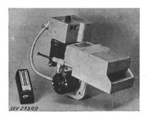
court-circuit. Commande du débit d'amenée du mazout par dispositif de réglage du niveau du mazout. Bornes de raccordement sous le couvercle de l'appareil de commande automatique monté sur le brûleur. Transformateur du circuit de commande pour 24 V, incorporé. Réglage de la vitesse de rotation du moteur et du débit du mazout par thermostat appliqué contre la chaudière.
