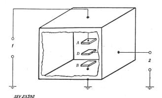
Fig. 1 Schematische Darstellung eines dielektrischen Potentiometers 1 Eingang; 2 Ausgang
