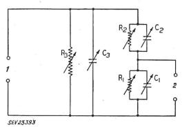
Fig. 2 Ersatzschaltbild des dielektrischen Potentiometers 1 Eingang; 2 Ausgang Weitere Bezeichnungen siehe im Text
