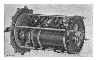
Fig. 3 Unterwasser-Fernsehkamera Demontiert
