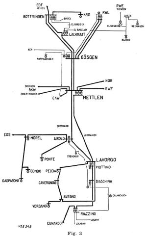
Schéma de principe du réseau à haute tension de l'Atel
