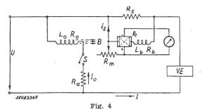
Schaltung eines Tonfrequenzwattmeters
