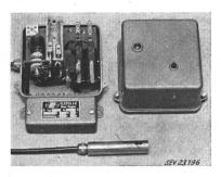
fonctionnement de la partie électronique avant chaque enclenchement. En cas de perturbation, l'installation est déclenchée par un déclencheur thermique. Bouton-poussoir de réenclenchement. Bornes de raccordement sous couvercle en tôle. Cellule photoélectrique reliée à l'appareil par câble spécial. Vis de mise à la terre.
