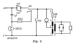
Teilnehmerapparat-Schaltung mit Gehörschutz-Gleichrichter a, b Sprechadern; nsa, nsi, nsr Nummernschalterkontakte;
