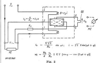
Multiplikationseinrichtung, beispielsweise zur Messung elektrischer Leistung MI Mittelwert-Instrument; OS Oszillographenschleife; VE Verbraucher
