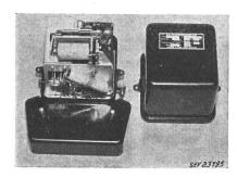
tation par transformateur de réseau. Un relais enclenche et déclenche le moteur et le transformateur d'allumage. Un interrupteur à déclencheur thermique déclenche en cas de perturbation. Bouton-poussoir de réenclenchement. Bornes de raccordement sous couvercle en tôle. Vis de mise à la terre.
