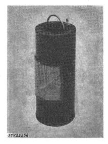
Fig. 1 Echo-Lokalisierungsapparat für Blinde
