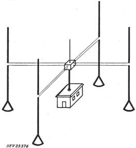
Fig. 2 Schematische Darstellung eines H-Adcock-Peilers
