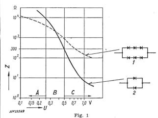
Widerstands-Spannungs-Kennlinien von Gehörschutz-Gleichrichtern
