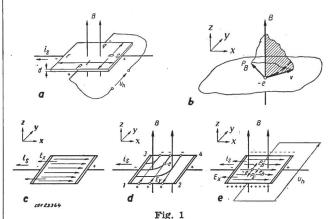
Entstehung der Hallspannung
