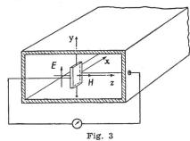
Anordnung zur Leistungsmessung bei hohen Frequenzen Halbleiter im Hohlleiter angeordnet (Ho-Welle)
