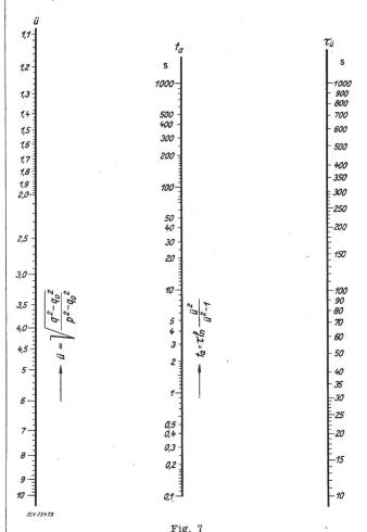
Nomogramm zur Errechnung der Auslösezeit, des «Zeitfaktors» oder des Überstromverhältnisses
