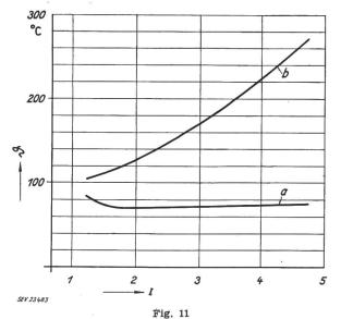
Gemessene Temperatur der Statorwicklung eines 1,5-kW-Drehstrommotors in Abhängigkeit von der Überlastung
