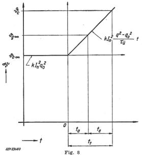
Temperaturanstieg bei Belastung mit Kurzschlußströmen  $\vartheta_{\theta}$  Temperatur bei Kurzschluss;  $\vartheta_{\theta}\infty$  Beharrungstemperatur bis zum Beginn des Kurzschlusses; Weitere Bezeichnungen siehe im Text und in der Legende zu Fig. 6
