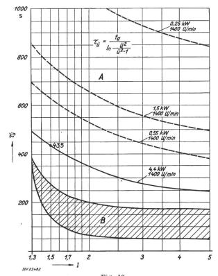
Fig. 10 Empirisch ermittelte Zeitfaktoren verschiedener Thermorelais und Motoren
