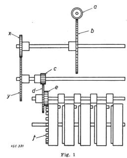
Vue schématique du système d'engrenages d'un totalisateur
