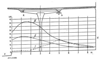
Fig. 2 Lichtverteilungskurven für Perron 1
