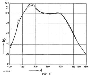
Relative spektrale Energieverteilung  $W_r(\lambda)$  einer Leuchtstofflampe «Tageslicht»
