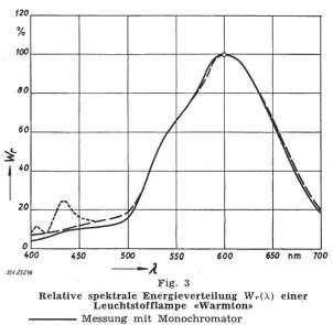
Messung mit Filtern
