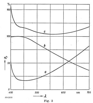
Spektrale Empfindlichkeiten p von Photozellen in Funktion der Wellenlänge λ
