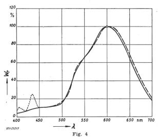
Relative spektrale Energieverteilung  $W_r(\lambda)$  einer Leuchtstofflampe «Warmton» Filtermessung mit der Photozelle 1P29 allein ausgeführt Weitere Erklärungen siehe Fig. 3
