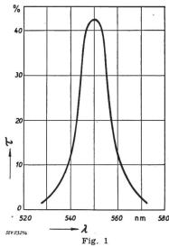
Spektrale Durchlässigkeit  $\tau$  eines Interferenzfilters in Funktion der Wellenlänge  $\lambda$
