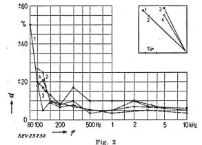
Maximale Abweichung vom 1/r-Gesetz in einem Kugelschallfeld in Prozenten des Absolutwertes für verschiedene Meßstrecken
