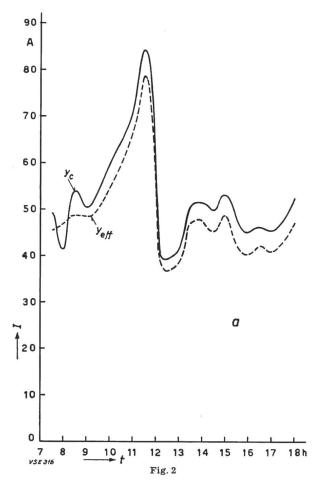
Fig. 2...10 Courbes de charge calculées, et mesurées moyennes des départs a...i
