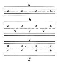
nicht störend beeinflusst, sondern unterstützt. Die beidseitige Installation der Lichtpunkte wird bei breiten Strassen, bei Strassen mit starkem Verkehr, auf Brücken und deren Auffahrtsrampen, bei Tun-
