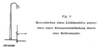
Für Kreuzungen und Einmündungen sollen abgeschirmte Leuchten verwendet werden, damit keine Blendungen auftreten.
