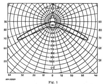
Lichtverteilungskurve einer Strassenleuchte mit ausgesprochen asymmetrischer Ausstrahlung in Längsrichtung der Strasse (Alumag S5001/2/3)
