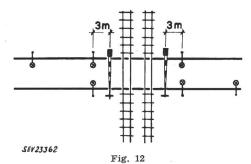
Anordnung der Lichtpunkte bei einem Übergang über eine zweigleisige Bahn, mit Barrieren
