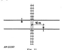
Anordnung der Lichtpunkte bei einem Übergang über eine eingleisige Bahn, ohne Barrieren
