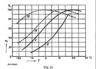
Abhängigkeit des Lichtstromes von Fluoreszenzlampen von deren Umgebungstemperatur
