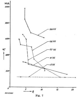
Verhältnis Q der Steilheit S\* bei halber Maximalleistung zur Steilheit S<sub>1</sub> bei maximaler Leistung (pro Netzpunkt), in Abhängigkeit der maximalen Leistung P<sub>1</sub>, nach dem Exponentialansatz berechnet
