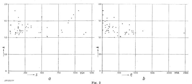
Bei Kurzschluss-Ausschaltungen in betriebsmässigen Netzen gemessene Amplitudenfaktoren k gemäss Tabelle II: a in Abhängigkeit der Steilheit S der wiederkehrenden Spannung; b in Abhängigkeit der Kurzschlussleistung  $P_{\theta}$
