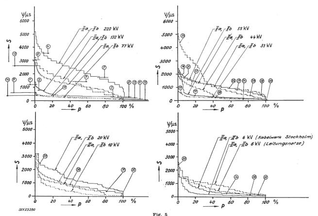
Zusammenstellung aller korrigierten kumulativen Kurven IIa und IIb für schwedische Netze Betriebsspannungen:
