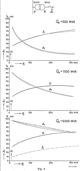
Kurzschluss auf der Sekundärseite eines Transformators 150/50 kV, welcher primärseitig an ein Netz angeschlossen ist Frequenz  $f_T$  und Amplitude  $A_T$  des nur durch den Transformator bedingten Teiles der wiederkehrenden Spannung, in Abhängigkeit der Transformator-Nennleistung. Kapazität der Primärseite, sowie Netz-Kurzschlussleistung  $Q_n$  vor dem Transformator als Parameter.
