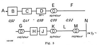
Rendements de la production thermique d'énergie triphasée à 50 Hz avec utilisation d'un groupe convertisseur de fréquence
