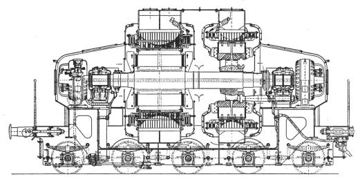
Fig. 7 Groupe convertisseur synchrone/synchrone roulant
