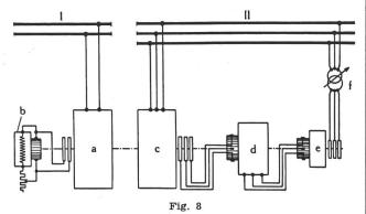
Schéma des connexions d'un groupe convertisseur couplé élastiquement au réseau
