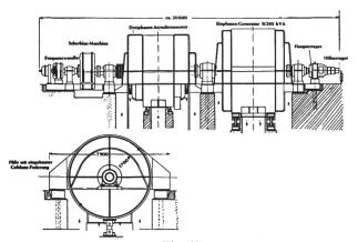
Fig. 12 Groupe convertisseur 50 Hz/16% Hz couplé élastiquement au réseau
