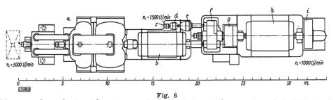
Groupe de machines pour la production d'énergie monophasée à 16¾ Hz et d'énergie triphasée à 50 Hz (système Marguerre)
