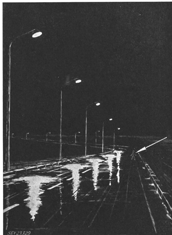
Fig. 4 Reflexstreifen nur links der Fahrspur des Beobachters; einseitige Leuchtenanordnung; sehr nasse Strasse Hindernis durch Pfeil verdeutlicht
