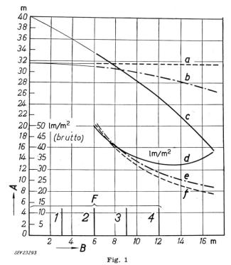
Lichtpunktabstände in Funktion der Strassenbreite und spezifischer Nutzlichtstrom
