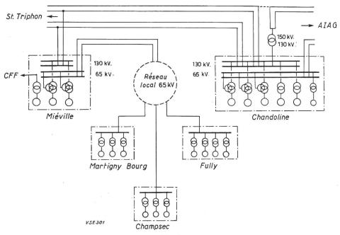
Fig. 1 Schéma sommaire des usines hydro-électriques de l'EOS
