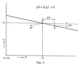
Caractéristique du réglage puissance-fréquence P puissance d'interconnexion; f fréquence
