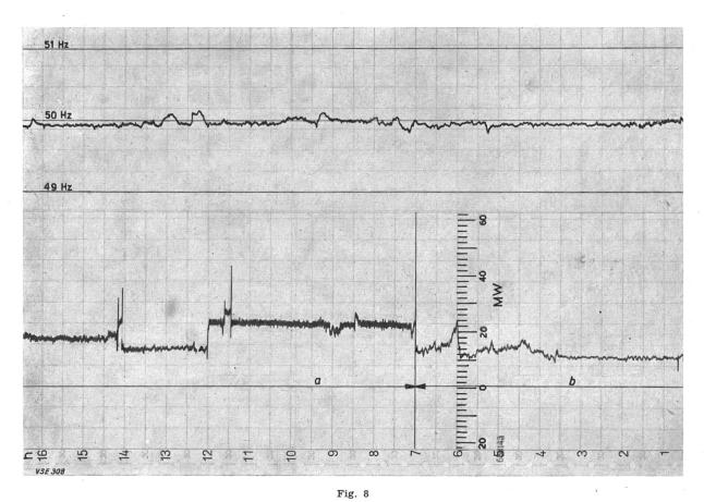
Diagrammes de la puissance d'interconnexion et de la fréquence à Galmiz, pour la journée du 22 octobre 1954 a réglage automatique de la puissance b réglage manuel de la puissance
