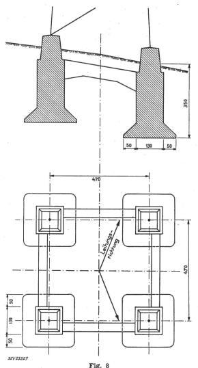
Riegelfundament eines Abspannmastes einer 225-kV-Leitung  $M_{\pi}=967$  tm; 1,5 Z=157 t;  $V_{B}=34,5$  m³
