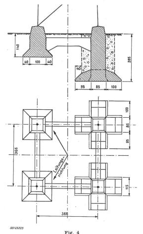
Riegelfundament eines Abspannmastes einer 150-kV-Leitung  $M_K = 465,3$  tm; 1,5 Z = 87,2 t;  $V_B = 13,1$  m³ Bodenbeschaffenheit: lehmige Moräne mit wenig Steinen
