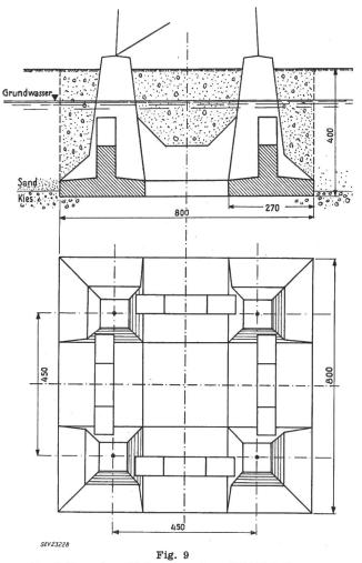
Fundation eines Endmastes einer 225-kV-Leitung  $M_K=927~{
