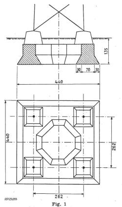
Unterschnittenes Rahmenfundament einer 150-kV-Leitung Kippmoment  $M_K=74.6$  tm 1.5-fache Pfostenzugkraft 1.5 Z=18.0 t Betonvolumen  $V_B=14.4$  m³
