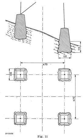
Felsfundation ohne Rundeisenanker für einen Abspannmast für eine 225-kV-Leitung
