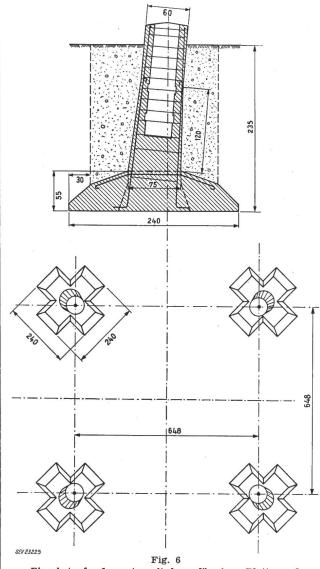
Eisenbetonfundamente mit kreuzförmiger Platte und geschaltem Stiel einer 225-kV-Leitung in Italien  $M_K = 338,3$  tm; 1,5 Z = 65,8 t;  $V_B = 7,6$  m³ Bodenbeschaffenheit: festgelagerter, kiesiger Lehm
