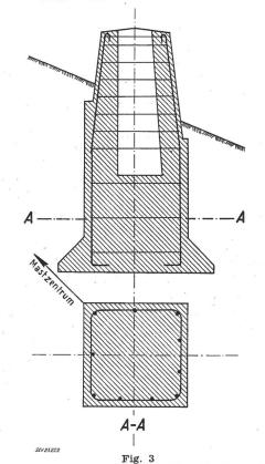
Schema der Armierung eines Einzelfundamentes
