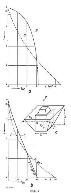
Vergleich der Erdkeilmethode mit dem Scherwertverfahren D Scherwert nach der Erdkeilmethode für  $\beta=30$ °; E Scherwert nach Versuchen in lehmiger Moräne; P Hubkraft nach der Erdkeilmethode für  $\beta=30$ °; C Hubkraft nach dem Scherwertverfahren; t Fundationstiefe;  $S_{DE}$  Scherwert;  $H_{FC}$  Hubkraft
