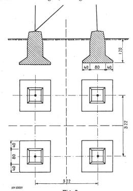
Fig. 2 Unterschnittene Einzelfundamente eines Tragmastes einer 150-kV-Leitung  $M_K = 89.7$  tm; 1.5 Z = 17.2 t;  $V_B = 5.4$  m<sup>3</sup>
