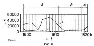
Beispiel des Wechsels von positiven und negativen Raumladungen des in Regenwolken getauchten San Salvatore A Station in Regenwolken eingetaucht (Südwind); B sturmartiger Nordwind, freie Sicht; n Anzahl positiver und negativer Träger pro cm³ Luft
