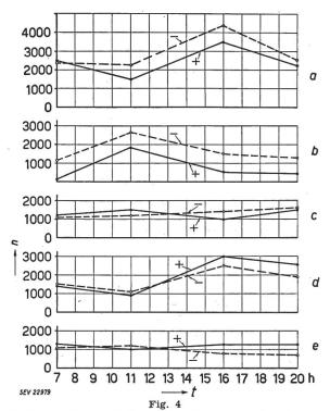
Beispiele des Ionengehaltes der Luft auf dem San Salvatore bei fünf verschiedenen typischen Wetterlagen a bedeckt bis bewölkt; b Nordwind, hell; c Stratokumuli 10/10; d hell und Dunst; e hell ohne Dunst n Anzahl positiver und negativer Träger pro cm³ Luft; t Zeit
