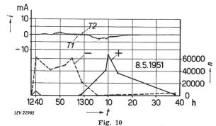
Verlauf der Ionendichte und des gleichzeitigen Glimmstromes an Turm T1 und T2 1. Beispiel
