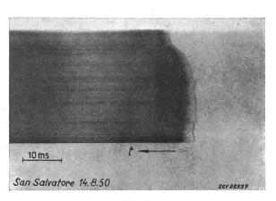
Fig. 22 Nach oben vorwachsender Blitz
