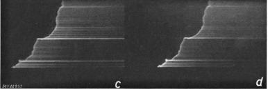
San Salvatore vorgelagerten Bergkuppe ausging. Die Aufnahme zeigt einen faden Lichtschein zuerst am Boden, der nach oben wächst, ohne jedoch einen scharfen Funkenkanal zu bilden. Anschliessend flammt dieser Kanal auf der ganzen
