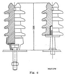
Les nouveaux types d'isolateurs rigides avec fixation dans la direction du conducteur
