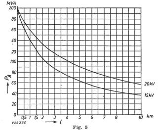
Augmentation de la puissance de court-circuit lors du passage de 15 à 20 kV, pour une ligne à 3 conducteurs de 95 mm² en acier-aluminium
