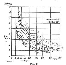
Gain en puissance transmissible obtenu par kg de métal en augmentant la section des conducteurs, en fonction de la tension de la ligne et du  $\cos\phi$
