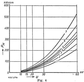
kW × km d'une ligne en fonction de la tension d'exploitation pour différentes sections des conducteurs et différents cos φ
