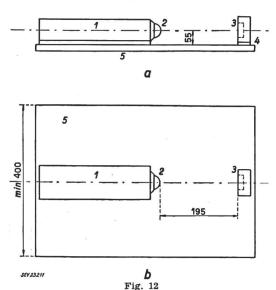
Aufstellung zur Eichung eines Phonmeters mit Entzerrung
