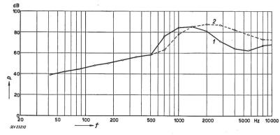
Oktavbandanalyse des Eichtones einer Kugelfallschallquelle
