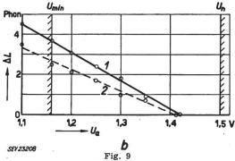
Abhängigkeit der Anzeige eines tragbaren Phonmeters von den Batteriespannungen
