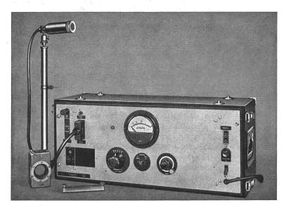
Zwischen dem Mikrophon (oder dessen Vorverstärker) und dem Verstärker ist ein Netzwerk eingeschaltet, dessen Frequenzgang denjenigen des Ohres approximiert. Da die Ohrempfindlichkeit
