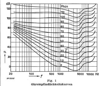
Kurven gleicher Lautstärke p Schalldruck in dB über Nullpegel  $2\cdot 10^{-4}~\mu b;~L$  Lautstärke; f Frequenz
