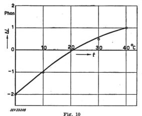
Temperaturabhängigkeit der Anzeige eines Phonmeters mit Kristallmikrophon
