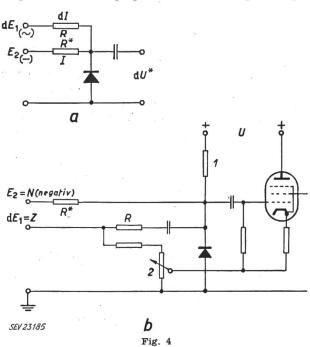
Prinzip der Division mit Hilfe der Differentialgleichung eines logarithmischen Elementes
