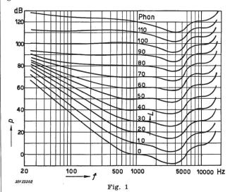
Ohrempfindlichkeitskurven Kurven gleicher Lautstärke p Schalldruck in dB über Nullpegel  $2\cdot 10^{-4}~\mu b;~L$  Lautstärke; f Frequenz
