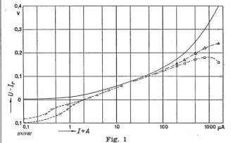
Charakteristik der Diode 1 N 48 (nach Daten des Herstellers, General Electric)
