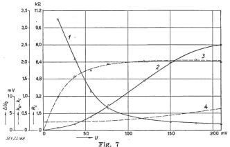
Einfluss der Trägerspannung auf die Eigenschaften des Modulators
