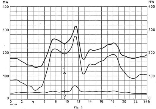
Couverture de la demande d'énergie dans le réseau triphasé des Forces Motrices Bernoises S. A. au cours d'un jour ouvrable d'hiver
