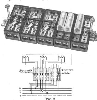
Messfeld- und Relaisprüfklemmen unten: Schaltschema für Drehstromzähler mit Prüfklemmen
