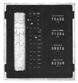
Fig. 2 Registrierempfänger in einem Kraftwerk
