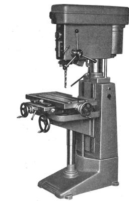
Fig. 2 Koordinaten-Bohrmaschine
