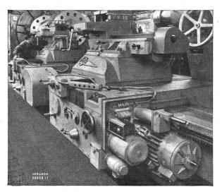
Fig. 2 Anwendung der elektrischen Welle in einer Grossdrehbank
