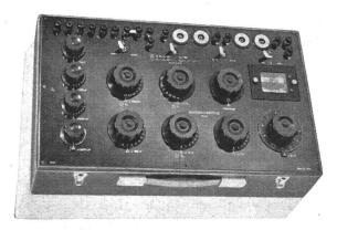
Fig. 1 Umschaltbare Präzisions-Kapazitäts- und Verlustfaktor-Messbrücke für Hochspannung nach Schering
