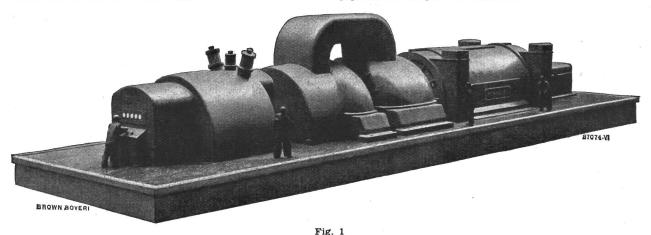
3 m langes Modell der 150 000-kW-Dampfturbogruppe im Kraftwerk Weisweiler, Deutschland links die Dampfturbine, rechts der wasserstoffgekühlte Turbogenerator; beide sind Pionierleistungen von Brown Boveri
