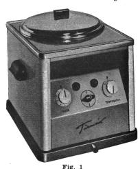
Eine noch wenig bekannte Maschine ist der Turmix-Industrie-Apparat. Dieser Apparat mit einem 3,3-kW-Motor zeichnet sich durch eine sozusagen unbegrenzte Vielseitigkeit aus. Er wird von führenden Betrieben, vor allem der chemischen und der Lebensmittel-Branche, aber auch von Drogerien, Kühlhäusern, Labors usw. zum Emulgieren, Pürieren, Mahlen, Zerfasern, Verflüssigen und Pulverisieren verwendet. Der Industrie-Turmix kann in der Ausführung den einzelnen Bedürfnissen weitgehend angepasst werden.
