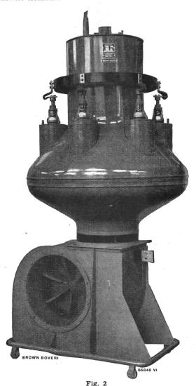
Neuer pumpenloser luftgekühlter Brown Boveri Sechsanodenmutator mit gesteuerten Gittern für den Kurzschluss- und Rückzündungsschutz sowie für die Spannungsregelung
