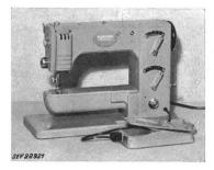
avec accouplement à friction, isolé à l'intérieur de la machine. Démarreur-régulateur à pédale, avec résistance en carbone. Lampe à incandescence de 15 W dans la tête de la machine. Interrupteur unipolaire à bascule encastré. Cordon de raccordement méplat à trois conducteurs, avec fiche 2 P + T et prise d'appareil 6 A, 250 V, 2 P + T.
