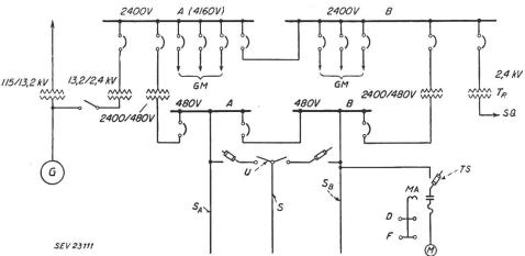
Niedrigere Erstellungskosten ergeben sich hauptsächlich durch Wegfall von grossen 480-V-Schaltern und langen Verbindungsleitungen. Die gewählte Anordnung der Motoranlasser und der kurzen Anschlussleitungen erleichtern die Übersicht und Wartung. Da keine besonderen Motorschalt-
