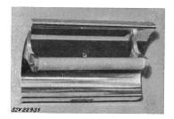
un tube de quartz. Réflecteur en tôle chromée. Borne de mise à la terre. Le radiateur n° 2 est prévu pour être suspendu. Cordon de raccordement à trois conducteurs sous double gaine isolante, fixé au radiateur, avec fiche 2 P + T.
