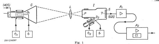
Zeilenumsetzer mit optischem Zwischenbild
